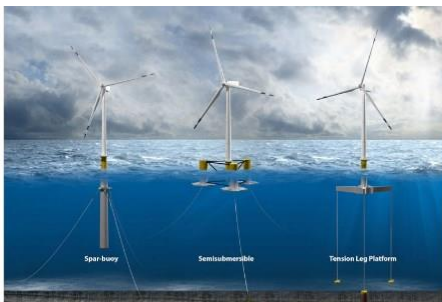
Figur 2-5: Prinsskisser av konsepter for flytende vind. Kilde: [5].
