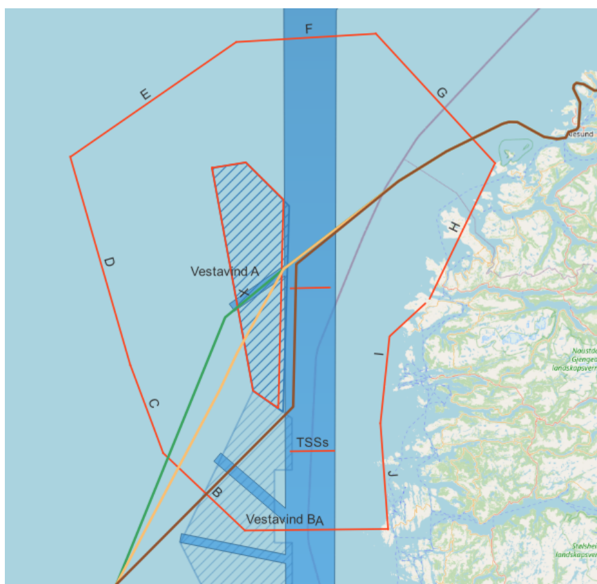
Figur 24. Endret seilingsrute for rute «G_X_X_B» i Vestavind A. Oransje linje viser dagens seilingsrute (A0), grønn linje viser rute med tiltaksalternativet med seilingskorridor (A1), og brun linje viser tiltaksalternativet uten seilingskorridor (A2). Skraverte områder viser definerte havvindsområder (NVE, 2023b), røde linjer viser navngitte passeringslinjer, og blått området viser seilingskorridorer og det etablerte TSS-systemet inkludert buffersone.
