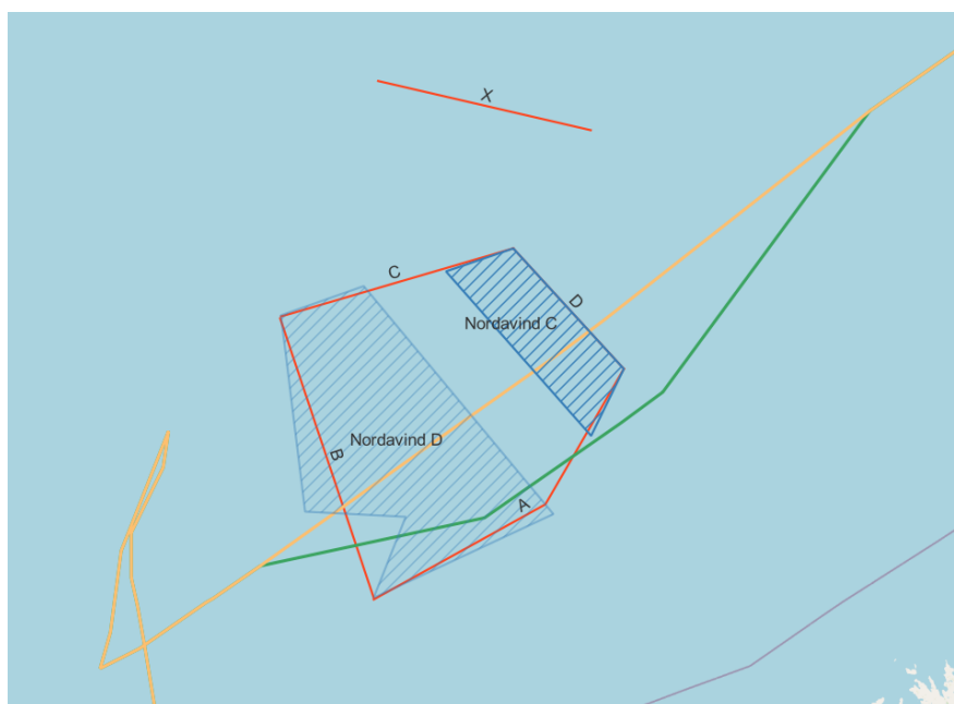
Figur 9. Endret seilingsrute for rute «B_D». Oransje linje viser seilingsrute i (A0) og grønn linje viser seilingsrute i (A1). De røde linjene viser navngitte passeringslinjer og skraverte områder viser definerte havvindsområder (NVE, 2023b).
