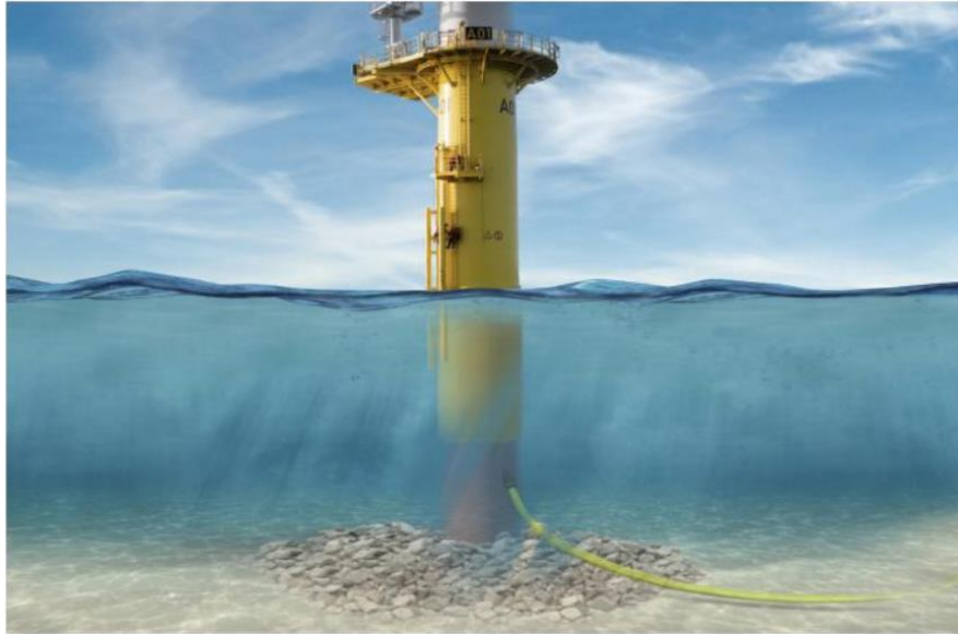
Figur 6. Eksempel på bunnfaste turbininstallasjon med kabel. Kilde: Trelleborg; gjengitt i Energy Global Magazine, Sommer 2020. Merk at her er kablen ikke tildekket, til illustrasjonsformål.
