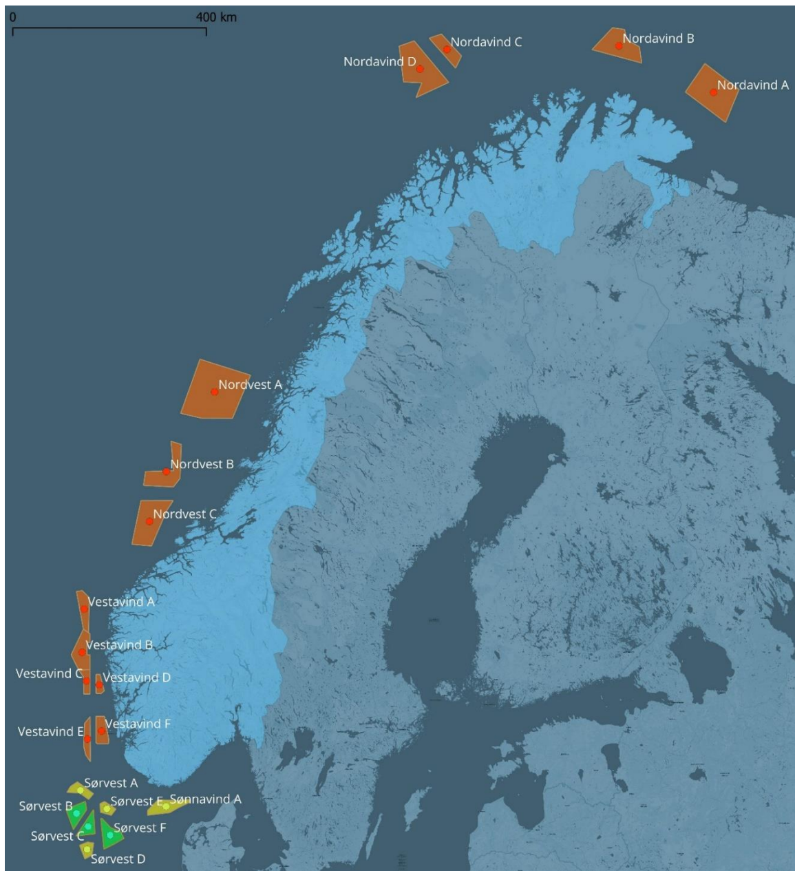
Figur 5: Havvindområder og tilhørende senterpunkter. Oransje angir områder der dybdeforholdene tilsier bruk av flytende turbiner, grønt angir områder der dybdeforholdene angir bruk av bunnfaste turbiner, mens gul farge angir områder i grensesjiktet mellom de to teknologiene, som i teorien kan benyttes av både flytende og bunnfaste fundamenter.
