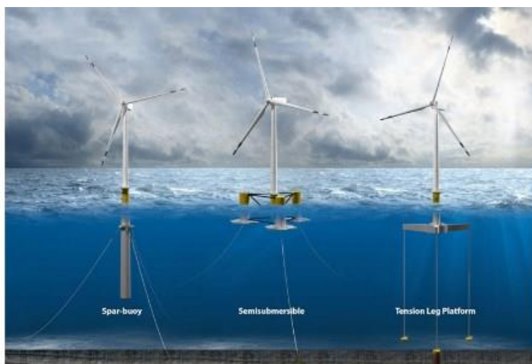
Figur 2-2: Prinsippskisser av konsepter for flytende vind. Kilde: [4].
