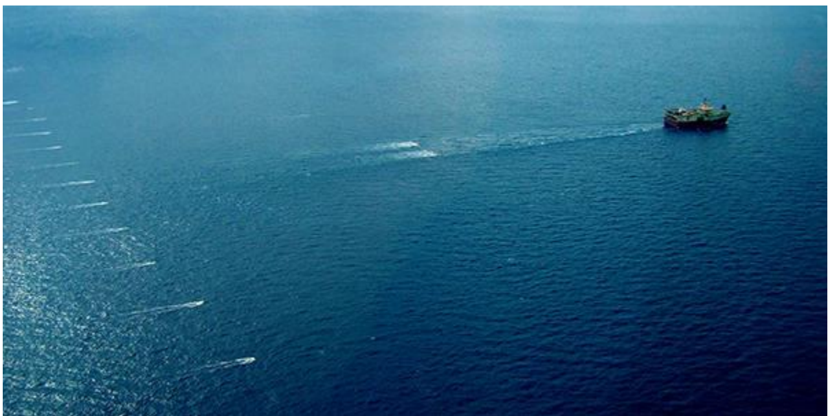
Figur 3 Ramform Vanguard samler inn seismikk (Foto: PGS)
