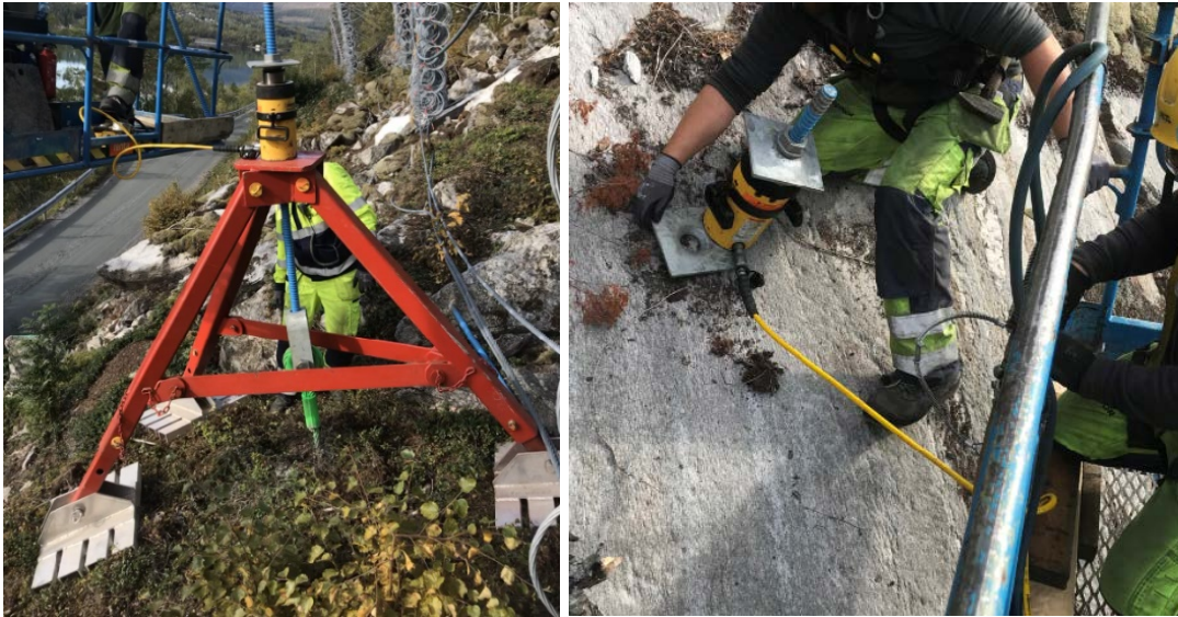
Figur 27. Til venstre prøving av stålvaier i ur/skredmasser, til høyre prøving av bolt i fast berg (Foto NGI/ Henrik Langeland).
