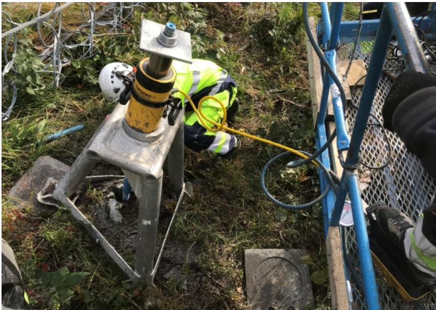
Figur 26. Prøving av selv borende stag gjennom tynt jorddekke med forankring i berg (Foto NGI/ Henrik Langeland).
